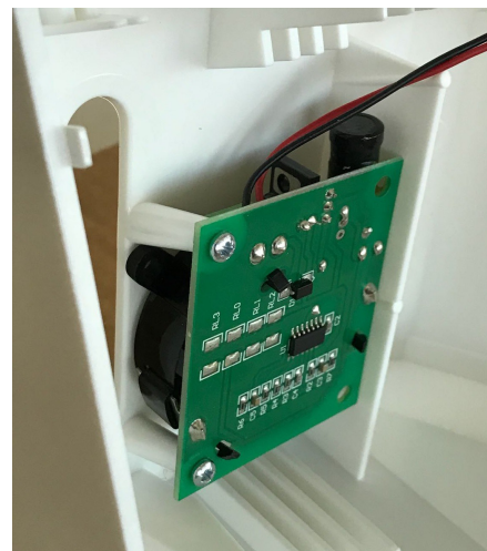
Figura 2 Montaggio della sirena interna
